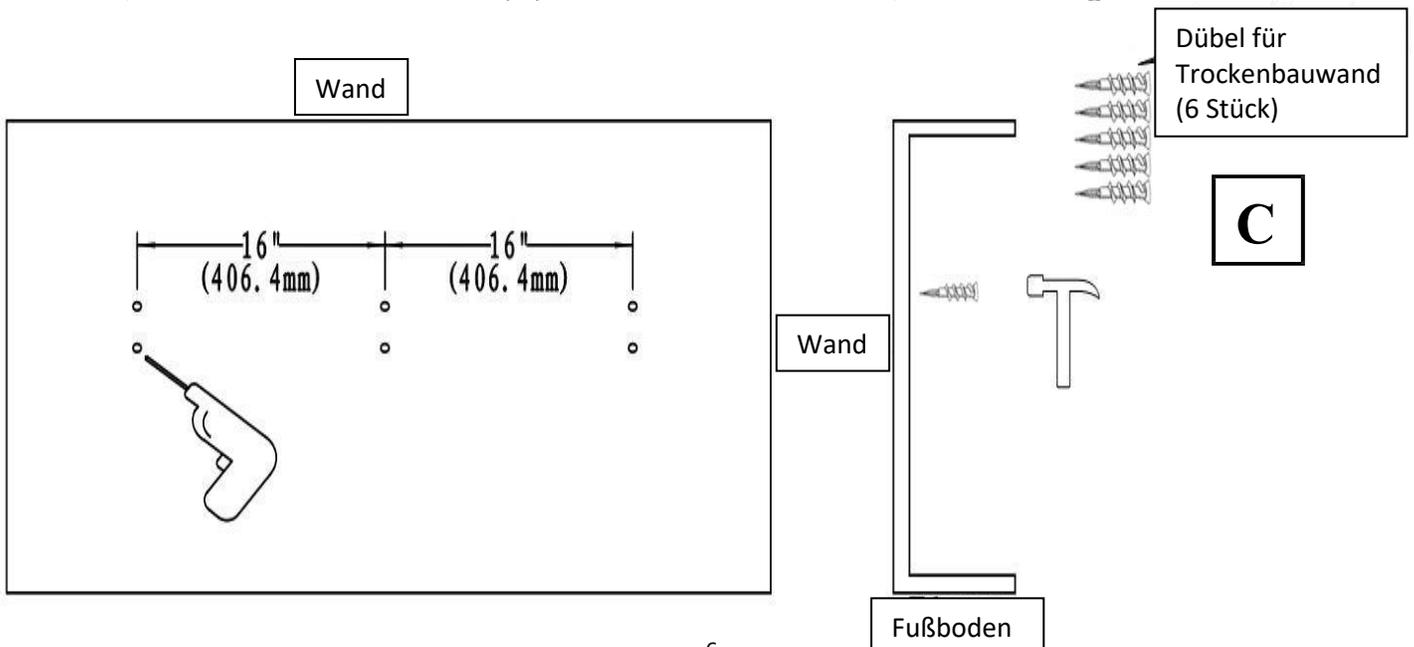
**SCHRITT 2)** Die Wandhalterung mit den sechs Holzschrauben (**B**) und mit Hilfe der Dübel an der Trockenbauwand befestigen. Alle Holzschrauben anziehen.
