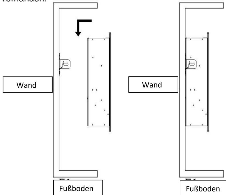
**SCHRITT 4)** Überprüfen Sie, ob das Gerät sicher/stabil montiert ist. Stellen Sie sicher, dass sich die Halterungen nicht von der Wand lösen. Anschließend die Halterungen der Montageleiste mit einem Schraubenzieher und zwei Schrauben ST4x8 (D) an beiden Seiten des Kamins sichern.
