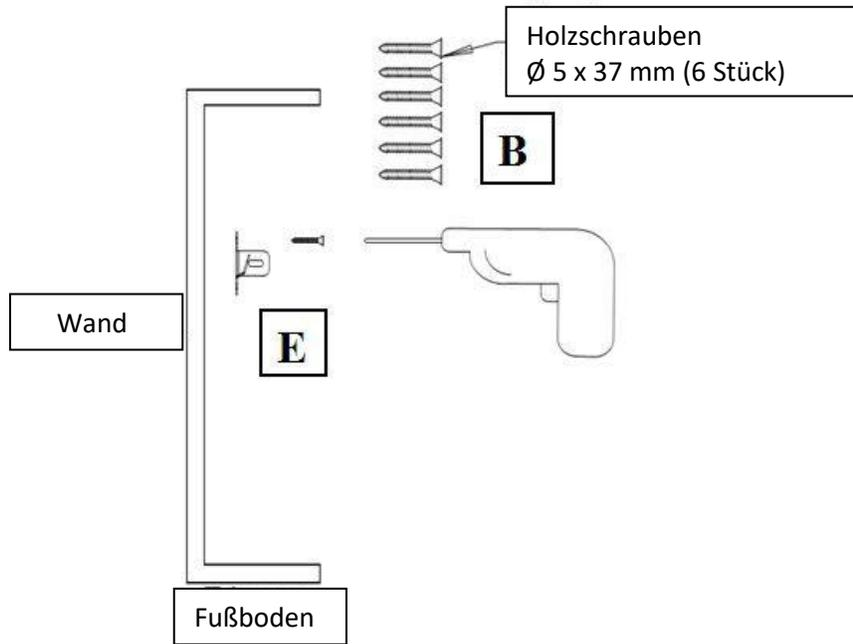
**SCHRITT 3)** Nachdem die Wandhalterung montiert ist, kann das Gerät mit **zwei Personen** in die vorgesehenen Haken eingehängt werden. Für die Haken an der Wandhalterung sind entsprechende Einlässe am Gerät vorhanden.
